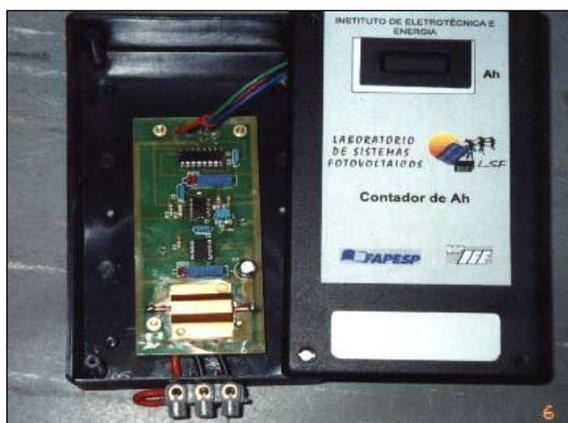
*Figura 1.3. Vista da placa, da caixa e a parte frontal do medidor de Ah.*
